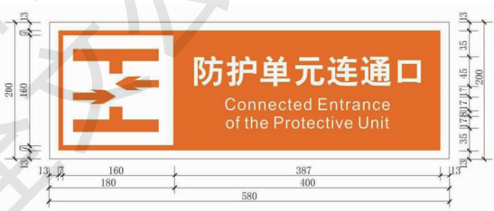
图 4.6.2 防护单元连通口标识牌样式及尺寸示例(图中单位为毫米)
